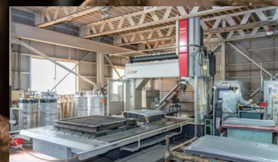
三次元レーザー加工機 OTHERS 発振器4kW、最大ワークサイズ2500mm×1600mm×550mm。成形・絞り加工後の三次元形状の加工やパイプのレーザー切断、在庫部品等への特殊仕様対応の追加工などさまざまな加工に対応いたします。
