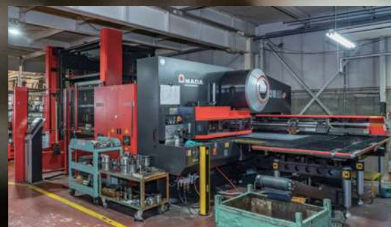
NCタレットパンチプレス BLANKING プレス能力30トン、最大材料サイズ2500mm×1270mm。素材供給・製品集積システムにより長時間連続自動運転が可能で高い生産能力を実現します。主に、板厚2.5mm以下の軟鋼、ステンレス、アルミの加工を得意とします。
