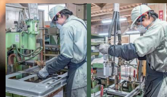
スポット溶接機 (定置式・ポータブル) ASSEMBLY 定置式12台、ポータブル3台でスポット溶接に対応いたします。ウエルドナットも対応可能です。
