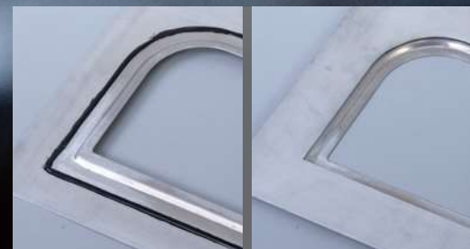
接着剤での接合事例です。熱硬化性の接着剤を使用しており、バス部品においては高い信頼性で幅広く用いられています。
