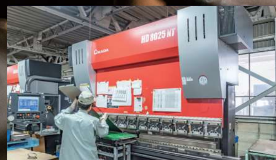
80トンベンディングマシン MOLDING / FORMING 最大曲げ長さ2570mm。V曲げ、Z曲げ、R曲げ、箱曲げ、ヘミング等さまざまな曲げ形状を実現します。合計6台のベンディングマシンで変種変量に対応します。
