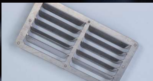
レーザー加工で切り込みを入れ、ベンディングマシンにより、曲げ加工を施したルーバー加工です。
