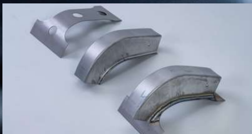
路線バスの天井骨格部品です。十数cmの絞り加工を施し、溶接ロボットで月産数百個生産しています。
