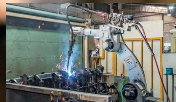
CO2溶接ロボット ASSEMBLY 4台のCO2溶接ロボットで中ロット生産にも対応します。また、CO2溶接機、MIG溶接機、TIG溶接機を取り揃えていますので、多様な材質の各種溶接に対応いたします。
