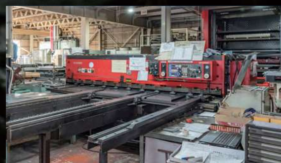
シャーリングプレス BLANKING 最大加工幅2400mm。銅板を切断する機械です。生産計画に基づき適切な切断を行い、高い歩留まり率を実現しています。
