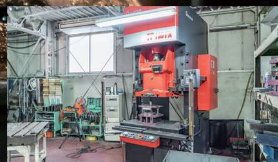
110トントルクバックプレス BLANKING MOLDING / FORMING 45トンから110トンまで取り揃えていますので、小物の変種変量にも対応いたします。
