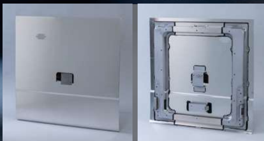
観光バスの荷物を収納するトランクの側面扉です。鉄の部品とアルミの部品を接着工法で接合し高い意匠を実現しています。
