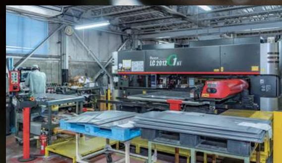
パンチレーザー複合加工機 BLANKING 発振器出力2kW、プレス能力20トン、最大材料サイズ2500mm×1270mm。軟鋼、ステンレス、アルミ、銅、真鍮、チタンなどさまざまな材質に対し、最大板厚6mmまで対応いたします。
