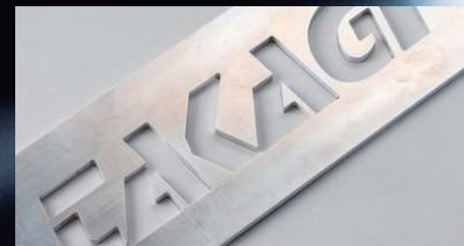
NCルーターでくり抜いた弊社のロゴです。きれいな切断面で任意の形状にくり抜くことができます。
