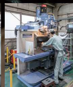
バリ取り機 OTHERS 最大ワーク幅600mm。バリのない製品を低コストで供給できます。
