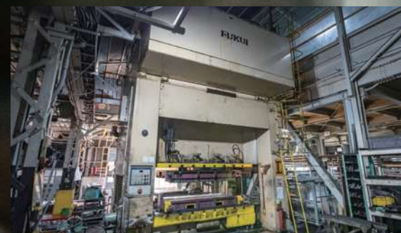
500トンダブルクランクプレス BLANKING MOLDING / FORMING ホルスターサイズ2800mm×1500mm。トリムから成形、絞りまで対応いたします。成形した製品は三次元レーザー加工機でのトリムも対応いたします。
