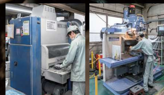
バリ取り機 OTHERS 最大ワーク幅600mm。バリのない製品を低コストで供給できます。
