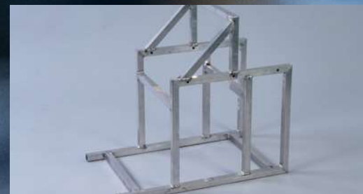
アルミパイプの溶接事例です。TIG溶接で歪みのない溶接を提供いたします。
