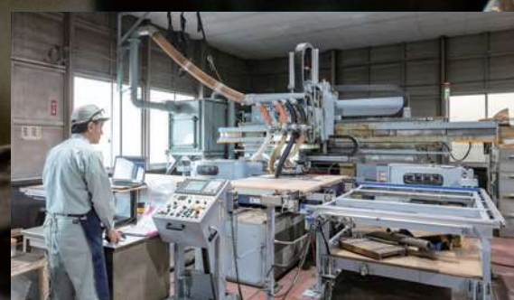
NCルーター BLANKING 最大材料サイズ2000mm×1300mm、最大板厚8mm。製品の外形をくり抜く機械です。レーザーで懸念される熱影響もなく、切削による高品位な切断面を実現します。アルミや真鍮、銅、樹脂の加工が可能で、ラミネートシムの加工も得意です。
