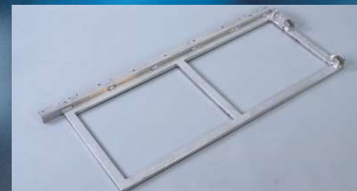
アルミパイプとアルミのアンクル等の溶接事例です。TIG溶接で接合しグラインダーできれいに仕上げます。
