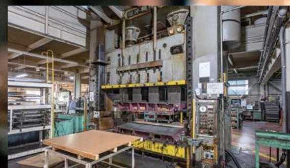
400トンダブルクランクプレス BLANKING MOLDING / FORMING ホルスターサイズ2800mm×1600mm。トリムから成形、絞りまで対応いたします。成形した製品は三次元レーザー加工機でのトリムも対応いたします。
