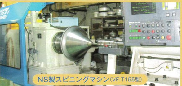
NS製スピニングマシン(VF-T155型)
